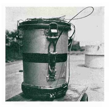
Bild 5 — Sandgefäß mit gesichertem Verschluß und Zugseil, das mit dem Kippseil fest verbunden ist. Kippseil am Boden des Sandgefäßes befestigt
