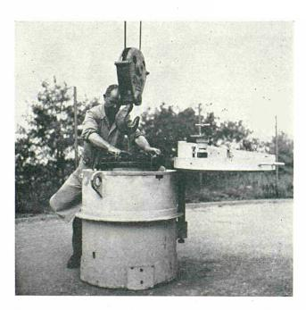
Bild 11 — Zentrierung des Sandgefäßes beim Einsetzen in den Abschirmbehälter
