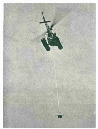
Bild 7 — Hubschrauber mit angehängten Backengreifer
