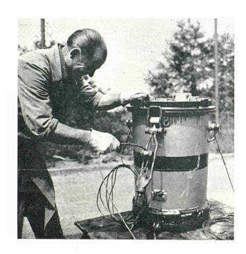
Bild 4 — Sandgefäß. Der eingesetzte Deckelverschluß wird durch Anzichen des Zugseiles in die Verriegelung gebracht; Halterungen für die Tragseile rechts und links unter dem Deckel
