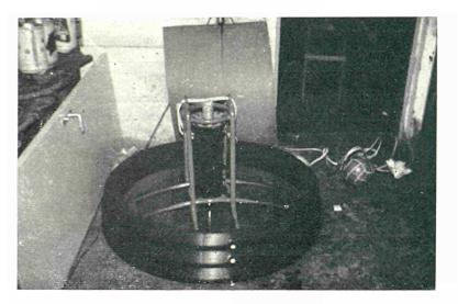
Bild 7 — Messung der Halbwertesdicke von natürlichem F
