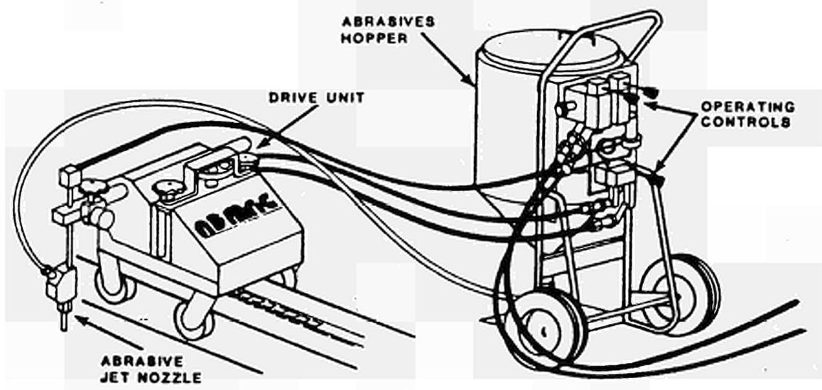
SYSTEM SET UP FOR STRAIGHT-LINE CUTTING
