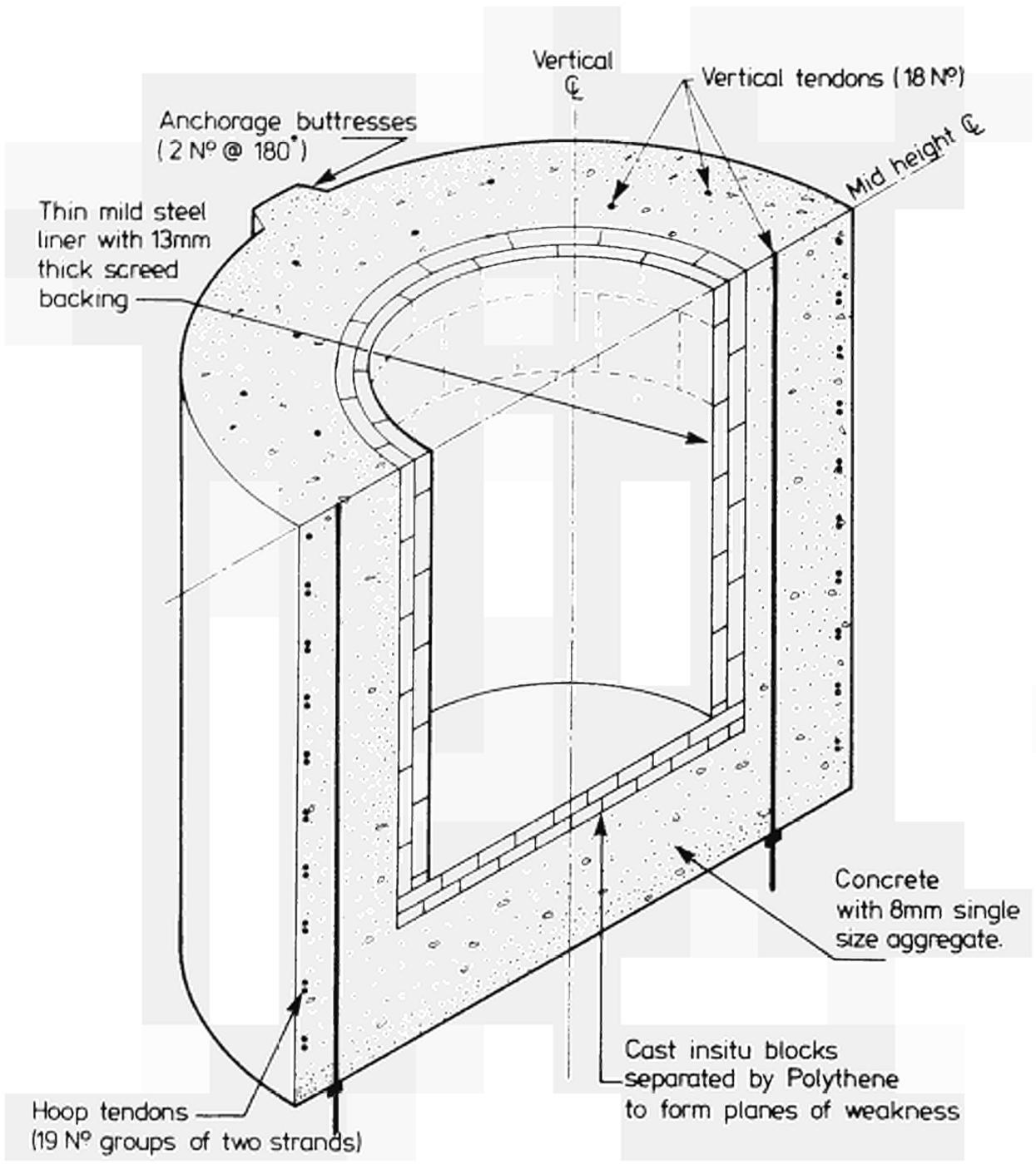
FIGURE 2 : QUARTER CUT AWAY VIEW OF MODEL WITH PLANES OF WEAKNESS
