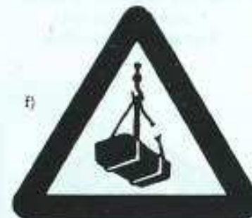
Kran i arbejde Warnung vor schwebender Last Beware, overhead load Charges suspendues Attenzione ai carichi sospesi Hangende lasten
