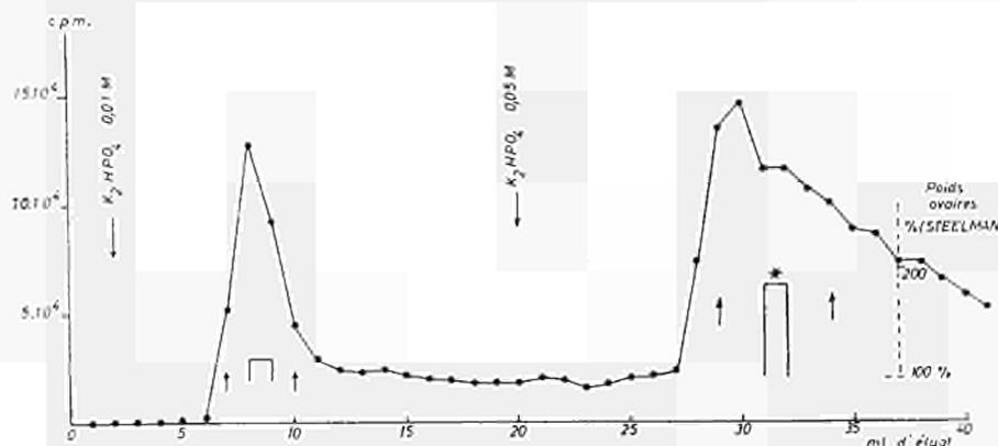
FIGURE 5. — Chromatographie de la préparation de FSH\* sur DEAE cellulose. Elution par  $\text{K}_2\text{HPO}_4$  0,01 M puis 0,05 M
