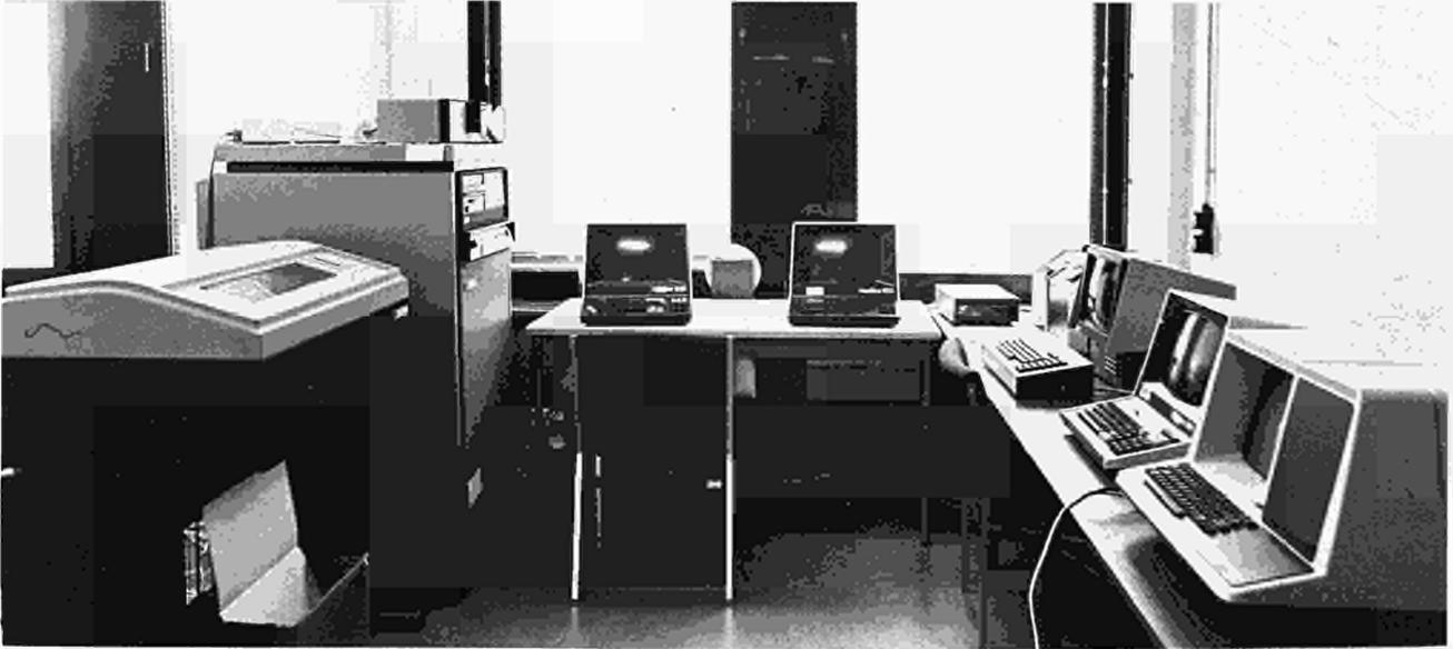
Fig. 93 CYBER batch terminal.
