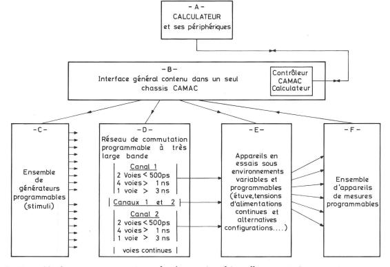
Fig. 1 Ensemble de mesures automatiques de réponses impulsionnelles sous environnements programmables. Schéma synoptique.
