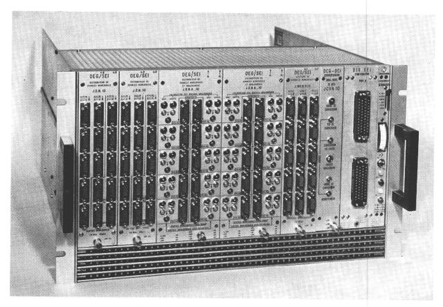
Fig. 3 Interface général (châssis CAMAC)
