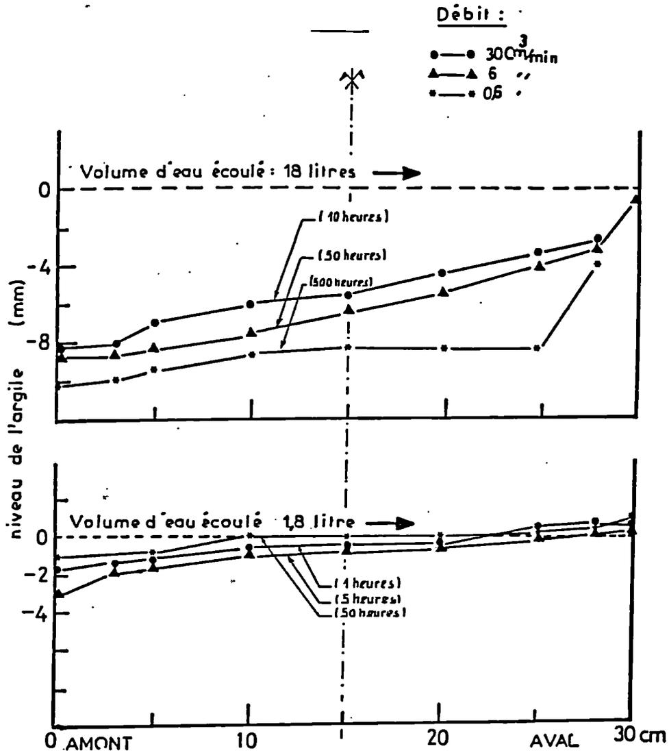
Fig.4 . Evolution du profil de la surface d'argile en fonction de la distance à l'entrée (Influence du débit pour deux volumes d'eau écoulés - Winit % = 399 %)
