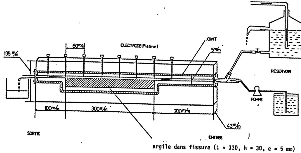
Fig.3 : Maquette de fissure avec argile expérimentale
