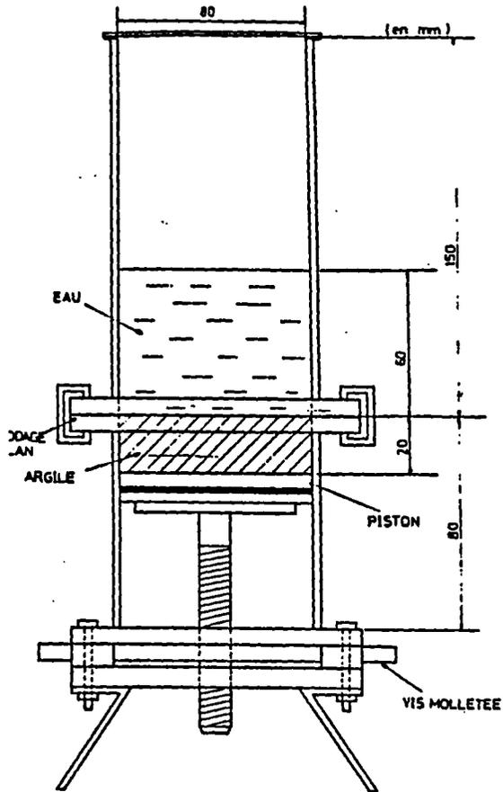
Dispositif expérimental pour l'étude de la distribution verticale de la teneur en eau dans l'argile
