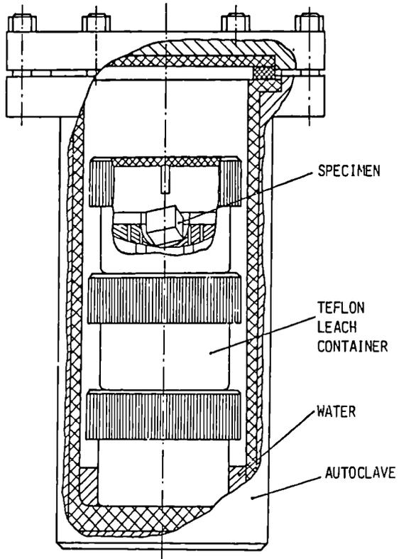
Fig. 33 : Leaching apparatus
