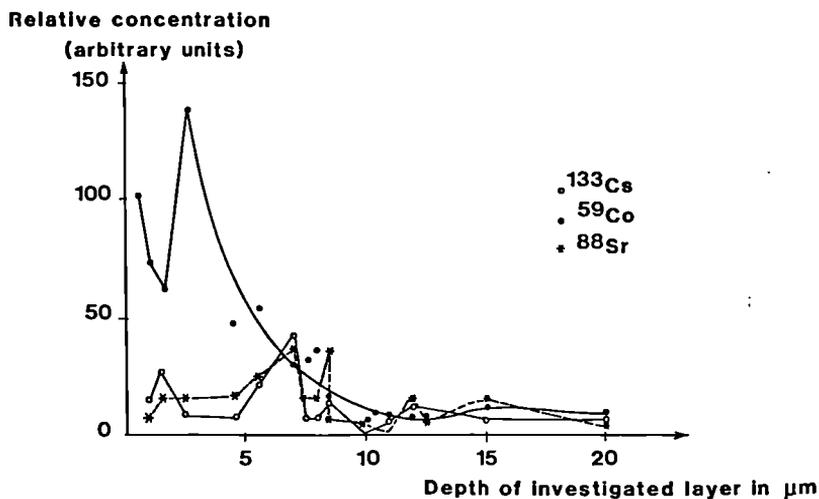
Fig. 8 : Diffusion of Cs, Sr, Co in epoxy matrix
