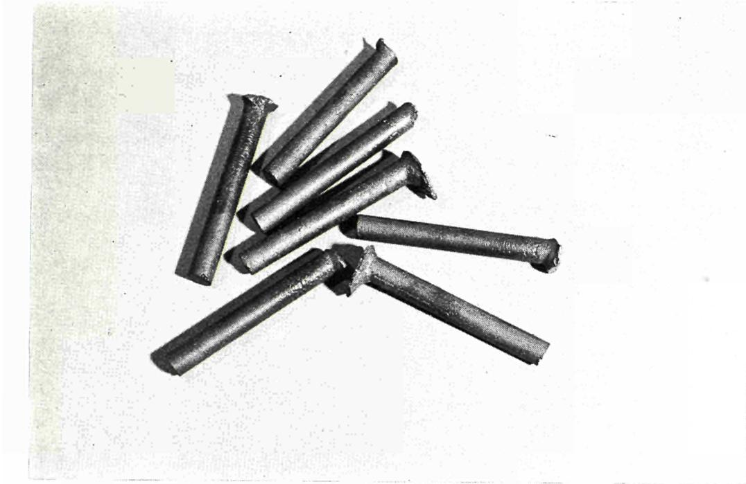
Abb. 13 — Gegossene UC-Stäbe mit 13 mm Durchmesser.
