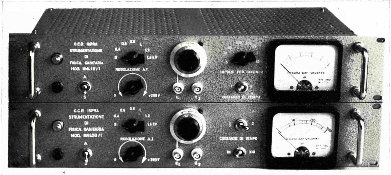
FIGURA 2. — Frequenzimetro lineare e logaritmico.
