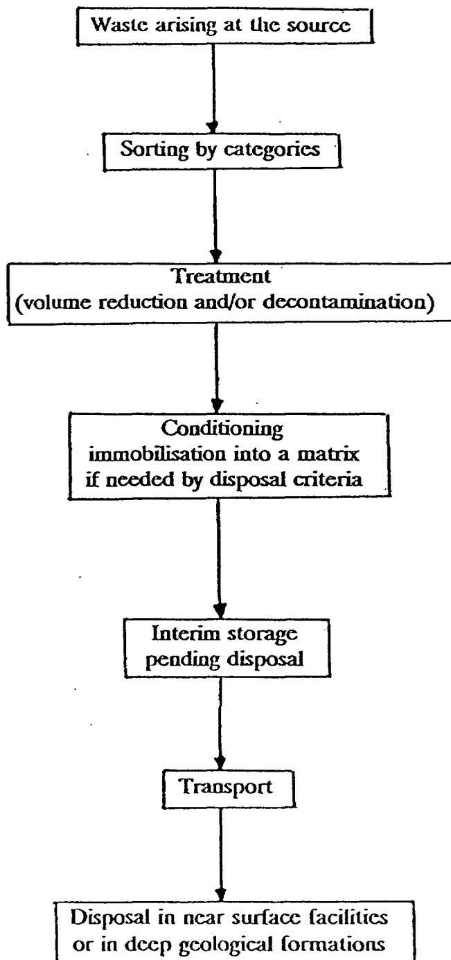
Fig. 1. TYPICAL RADIOACTIVE WASTE MANAGEMENT SCHEME
