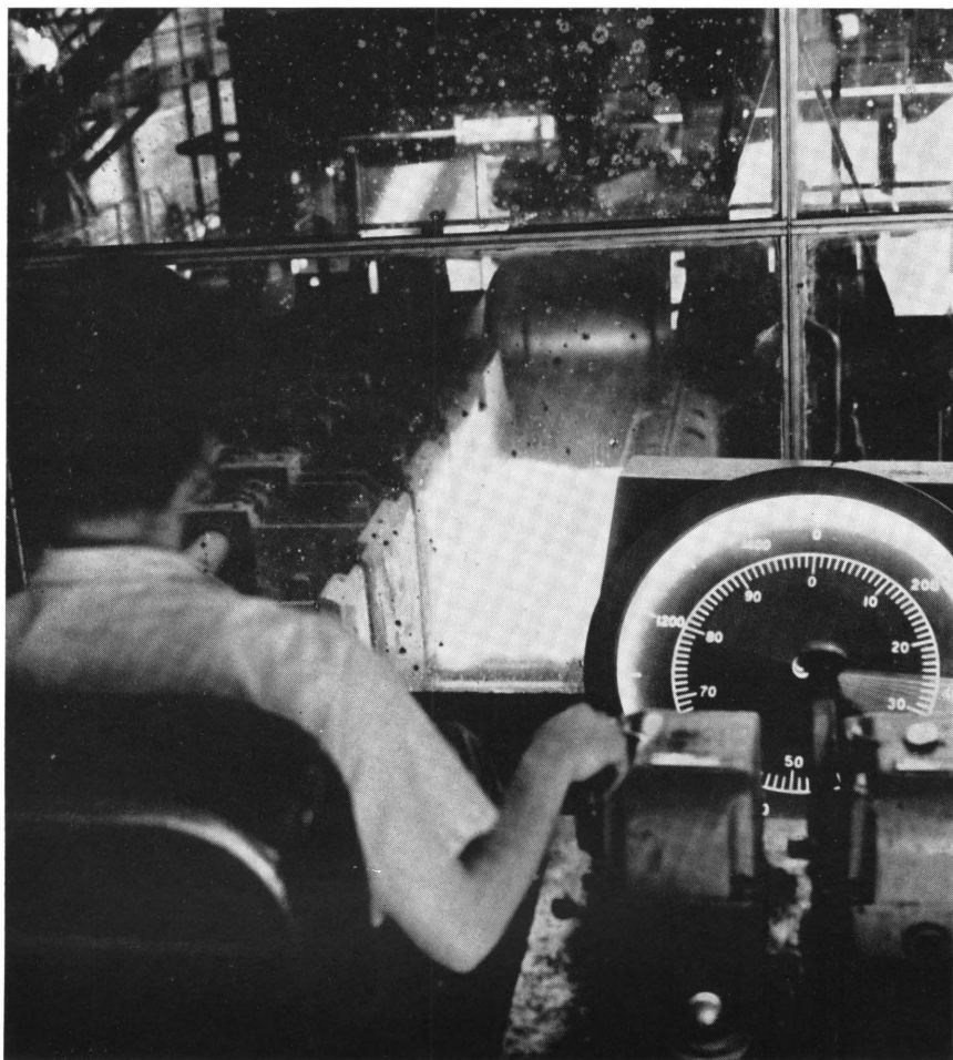
Poste de commande d'un blooming — le lamineur (Cliché: Philippe R. Doumic)
